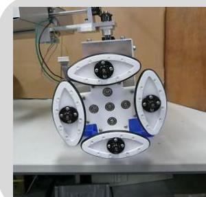
平地走行時には、車輪としての走行性能を持ち、段差がある場所では、車輪を変形させて段差を乗り越えることができる機構を持っているので、平地でも段差でも好適に移動することができる。
