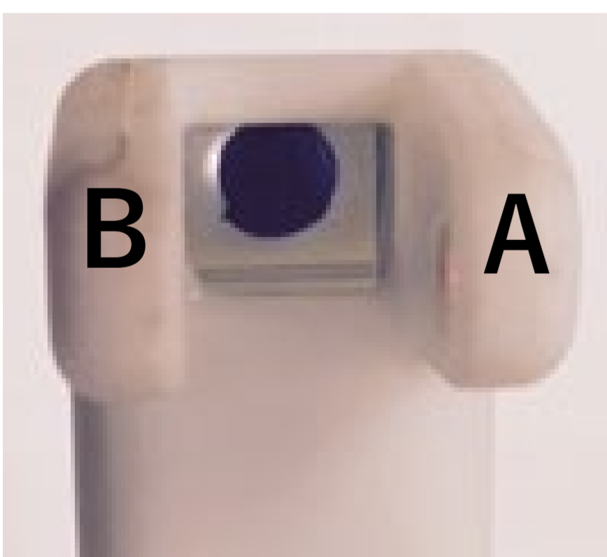
カメラ部側面内側 AとBから光を 被写体(歯)に照射
