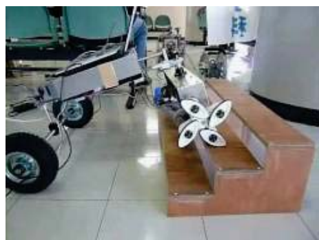
展開車輪による移動車両
