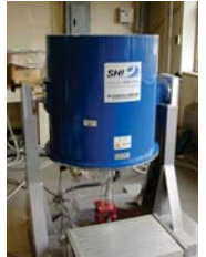
Fig. 2. 12T 超伝導マグネット (物質・材料研究機構 所有)
