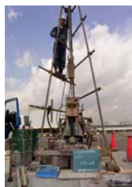
写真1 標準貫入試験概要
