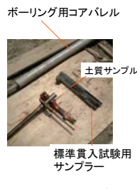
写真1 標準貫入試験概要
