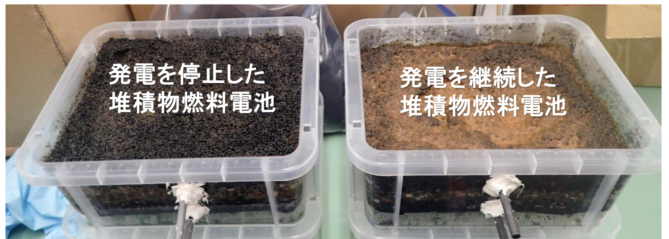
図-3 発電の有無によるチョウバエ発生数の違い 図-4 発電の有無による堆積物(濃縮下水汚泥)の色の違い
