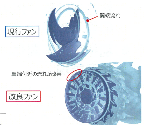
図3 羽根車まわりの流れ場予測結果
