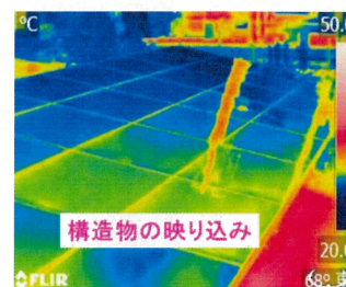
図2 熱画像への外乱 (赤外線カメラの通常的使用方法では、外乱により熱画像が正確な温度を表示しない可能性あり)
